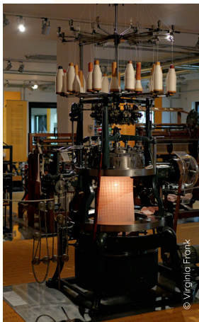
Interlock-Großrundstrickmaschine von der Schubert und Salzer Maschinenfabrik AG aus 1935
